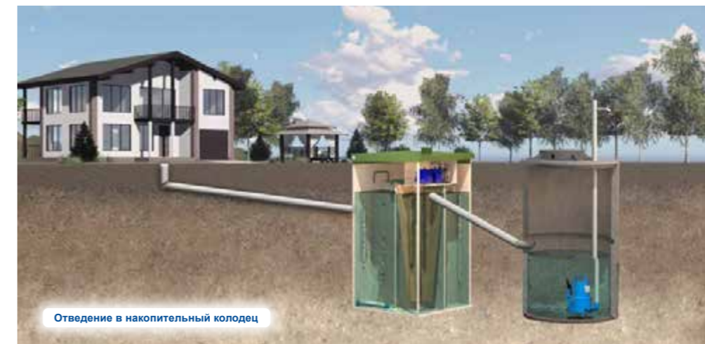
Отведение в дренажную канаву через накопительный колодец
