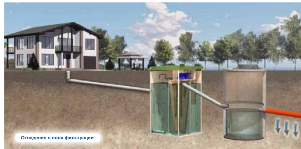
Отведение в дренажный колодец
