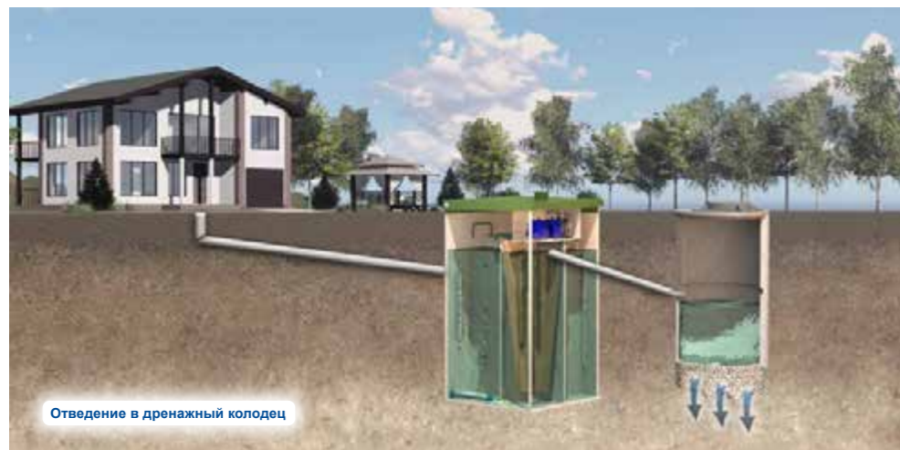
Схема отвода очищенной воды
